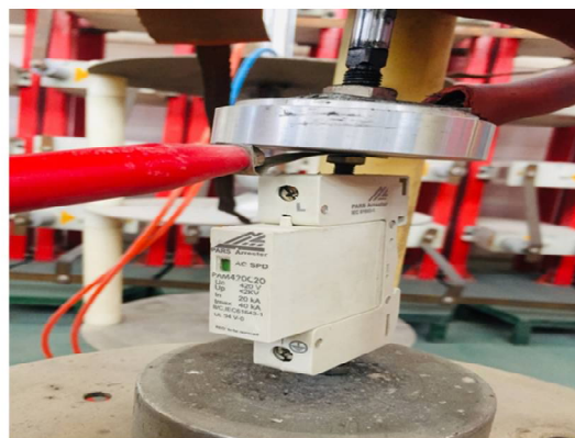
شکل ۱: نمایی از نحوه اعمال پالس های جریانی با مشخصه ۸/۲۰ میکروتانیه (مدلسازی اضافه ولتاژ ناشی از کلیدزنی در شبکه در حالت گذرا) با سطوح ولتاژی مختلف بر روی ترمینال های ارستر کلاس ۴۲۰ ولت
